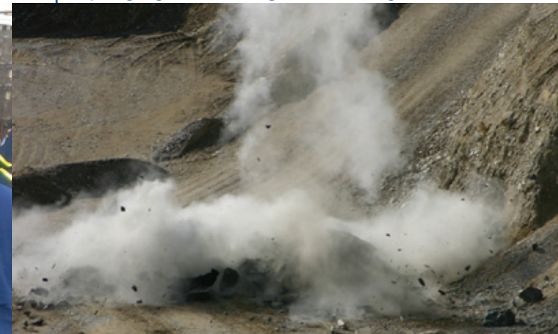
Sprengung eines Findlings in einer Kiesgrube.
